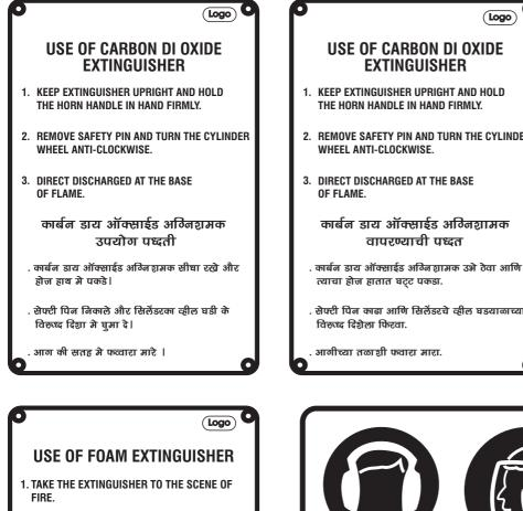
2. PULL & UNLOCK THE PLUNGER OF CYLINDER.
